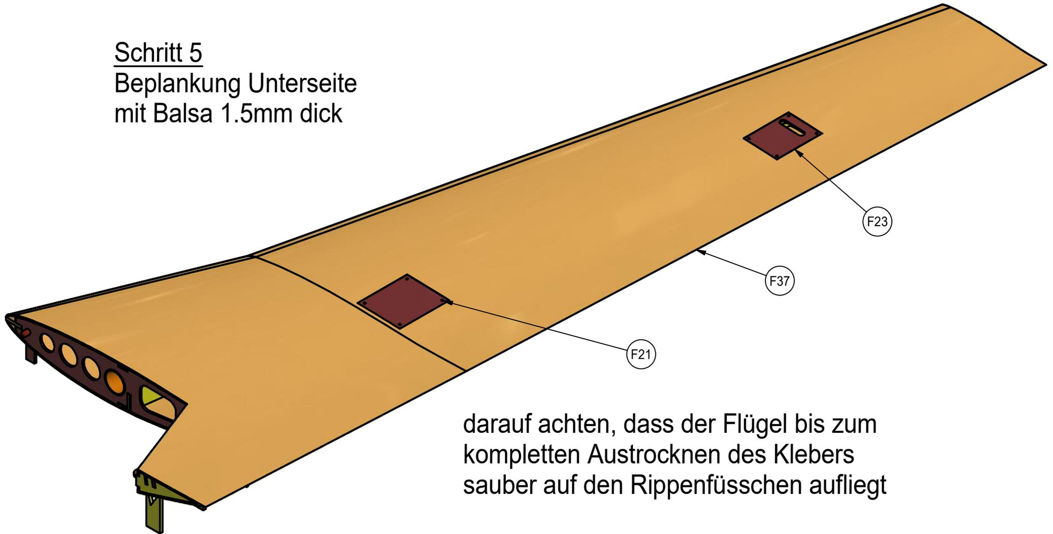
darauf achten, dass der Flügel bis zum kompletten Austrocknen des Klebers sauber auf den Rippenfüsschen aufliegt
