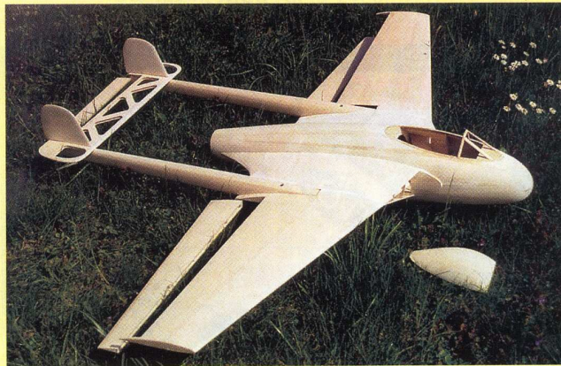
Der Rohbau der Venom: vollbeplankt, dennoch sehr leicht.
