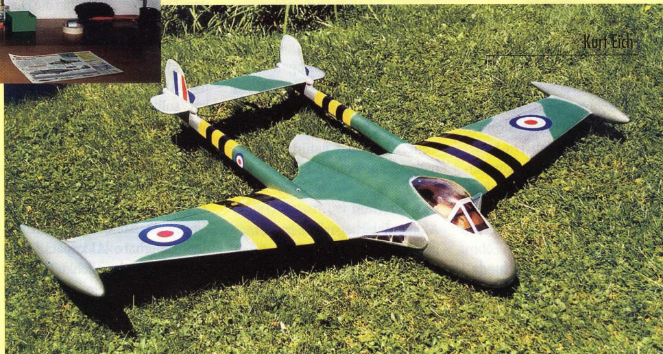
Das Modell ist komplett mit dünnem Papier bespannt und nach einer entsprechenden Oberflächenbehandlung gespritzt.
