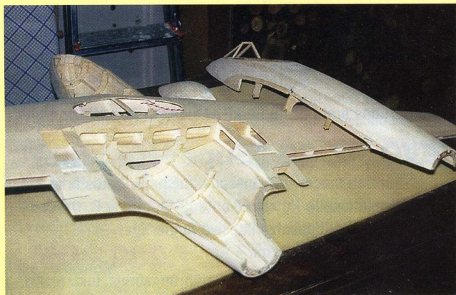
Der Rumpf wird in Halbschalenbauweise ganz aus Balsa aufgebaut. Ungewöhnlich ist die horizontale Teilung.
