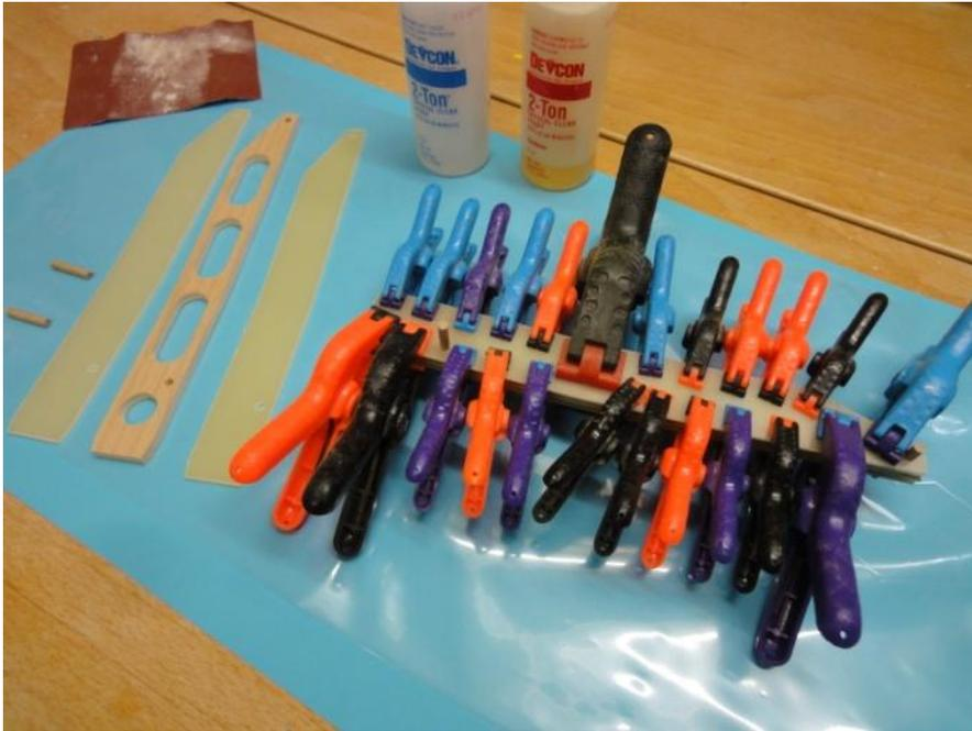
An den fertigen Zungen eventuell übergequollenen Klebstoff wegschleifen. Anschliessend das stumpfe Ende bis zum Knick mit sehr feinem Schleifpapier rundum polieren.
